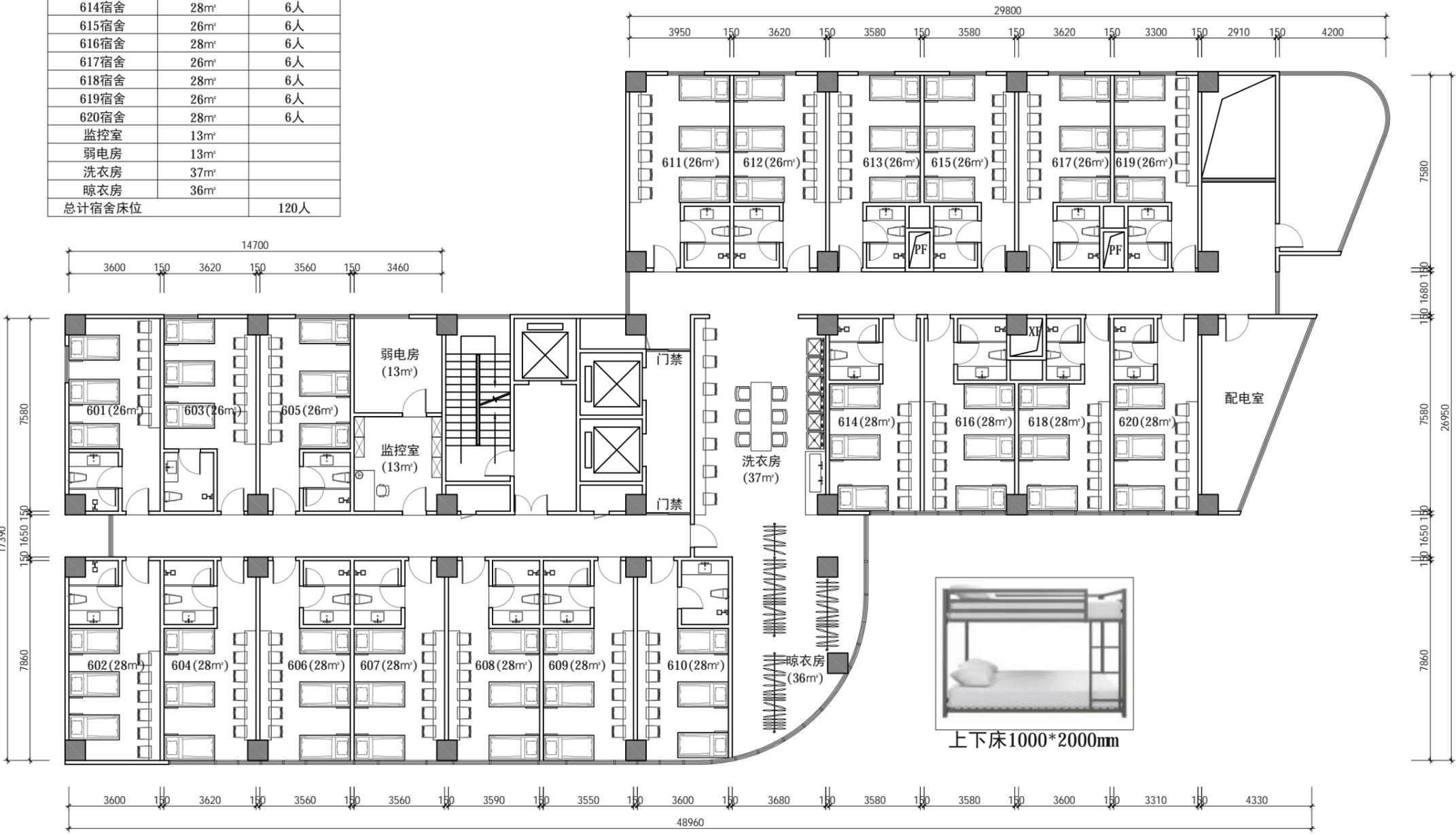
PLAN SCALE 六层平面布置图 1:180@A3
